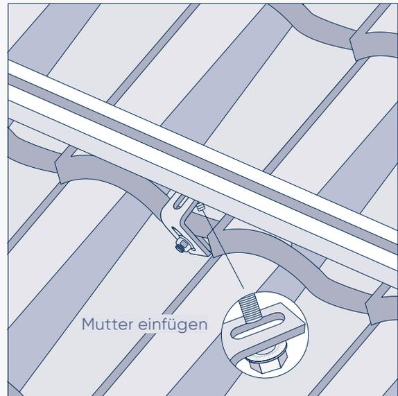
Danach verschraubst Du alle montierten M10 Schrauben mit den beigelegten Sechskantmutter.
