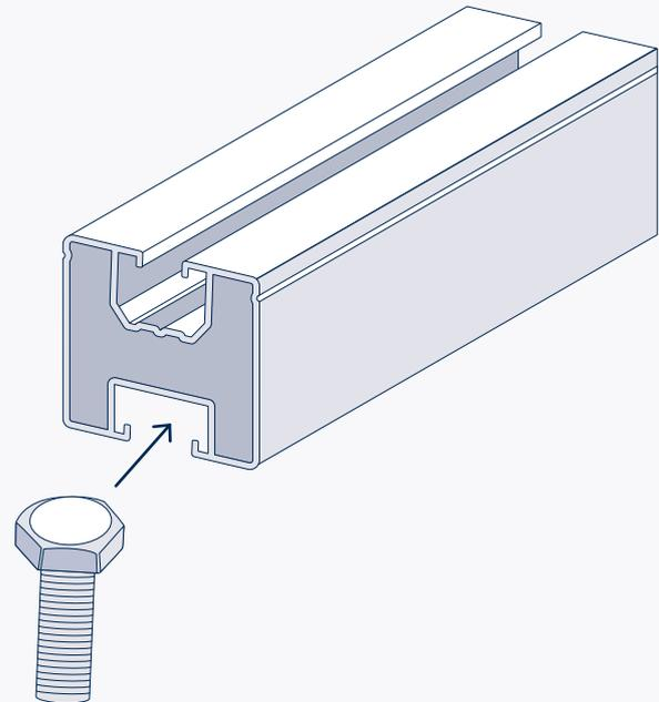
Platziere die M10 Schrauben so auf der Montage-schiene, dass diese durch die Öffnung der Dachhaken gesteckt werden können. Achte darauf, dass die Schiene maximal 450 mm nach außen übersteht.
