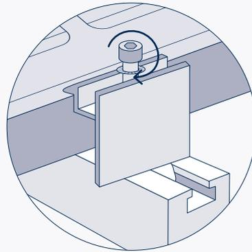
Befestige im Anschluss das zweite Solarmodul an der Außenseite ebenfalls mit den Endklemmen (siehe Seite 68).
