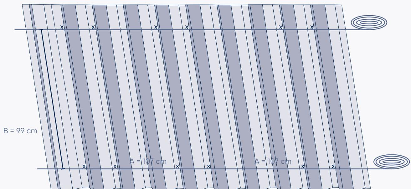
Nachdem die Schienen auf der Hochsicke platziert sind, können sie mit den Dünnschrauben befestigt werden.
