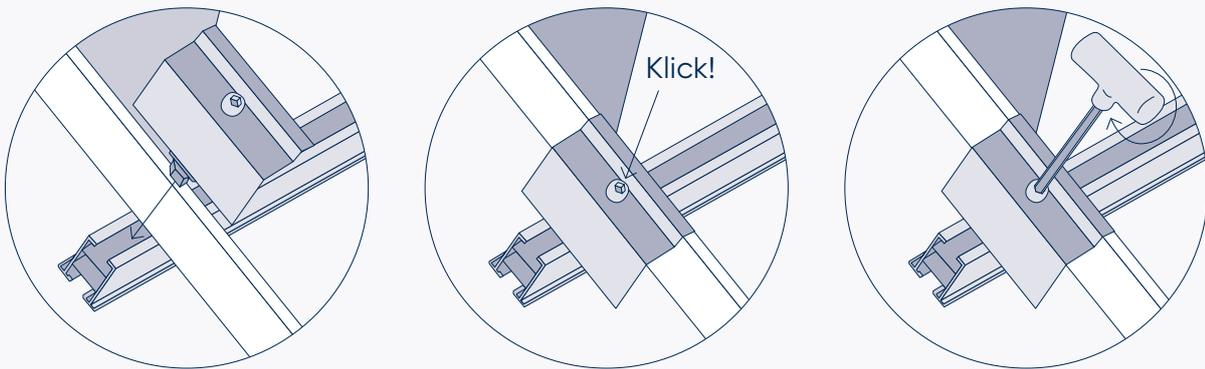
Lege nun das zweite Solarmodul neben das erste und verbinde beide mit den Mittelklemmen. Befestige im Anschluss das zweite Solarmodul ebenfalls mit den Endklemmen.
