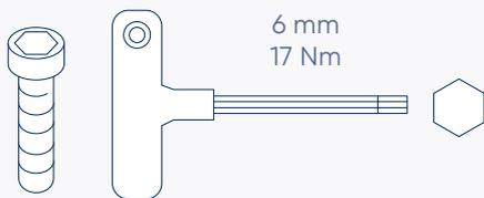
**03 Befestige pro Aufstelldreieck 4 Klemmpunkte. Zwei im oberen Viertel (jeweils ein Klemmpunkt links und rechts) und zwei im unteren Viertel (jeweils ein Klemmpunkt links und rechts) der Schiene.**
