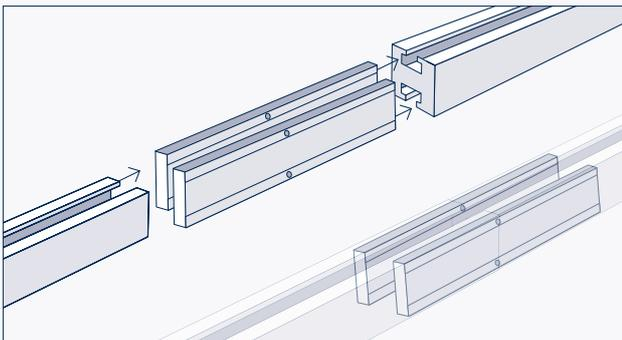
montierten Montageschiene, welche du erweitern möchtest. Anschließend nimmst Du die lose Montageschiene und schiebst diese über die gerade eingesteckten Verbinder bis zum Anschlag, sodass eine schlüssige Verbindung entsteht.
