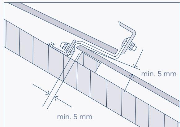
Nach der Montage der Dachhaken können die entnommenen Ziegel wieder aufgelegt werden, dafür müssen die Ziegel flach aufliegen, um die Dichtigkeit der Dacheindeckung zu gewährleisten. Das heißt, die Ziegel müssen im Wellental ausgespart werden.
