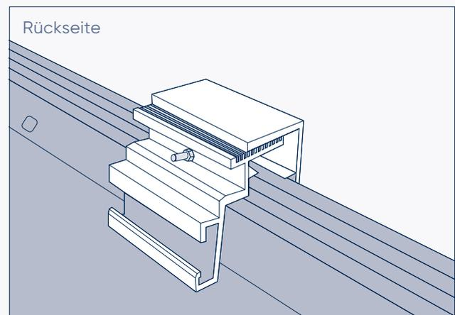
Im nächsten Schritt erfolgt der Gebrauch der mitgelieferten Hammerkopfschraube. Sie lässt sich ganz einfach in den dafür vorgesehenen Kanal der Halterung und in die Aussparung am Wechsel-
