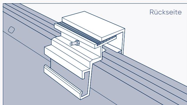
Im nächsten Schritt erfolgt der Gebrauch der mitgelieferten Hammerkopfschraube. Sie lässt sich ganz einfach in den dafür vorgesehenen Kanal der Halterung und in die Aussparung am Wechsel-
