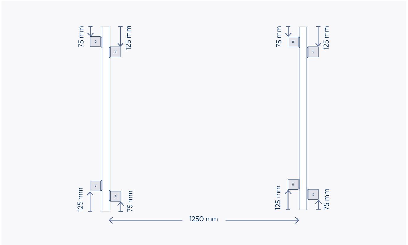
**04 Verwende für die Klemmstücke M10 Schrauben inkl. Unterlegscheibe und entsprechend für Deinen Untergrund geeignete Dübel.**
