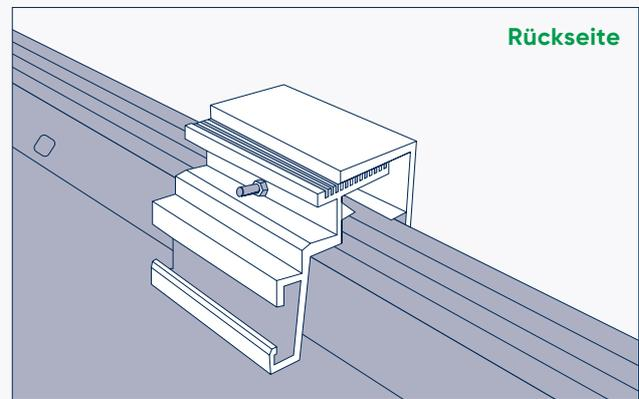
Im nächsten Schritt erfolgt der Gebrauch der mitgelieferten Hammerkopfschraube. Sie lässt sich ganz einfach in den dafür vorgesehenen Kanal der Halterung und in die Aussparung am Wechselrichter schieben. Mit dem Einsatz der dafür vorgesehenen Scheibe und Mutter kannst Du die Hammerkopfschraube nun ohne Bedenken festziehen.
