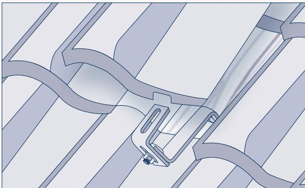
Durchführung des Dachhakens mit einem Trennschleifer auszusparen. Bei Dachsteinen (z.B. Frankfurter Pfanne) ist nur der obere Dachstein auszusparen.
