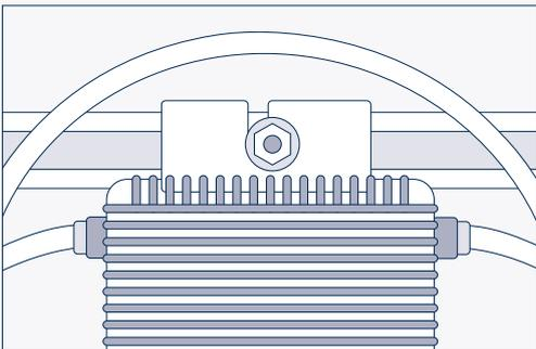
ein und drehe die Schraube um 90°. Ziehe sie darauffolgend mit einer Sperrzahnmutter an.
