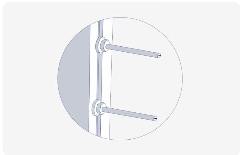
Achte darauf, dass der Strich auf der Schraube im 90° zur Schienenrichtung ist.
