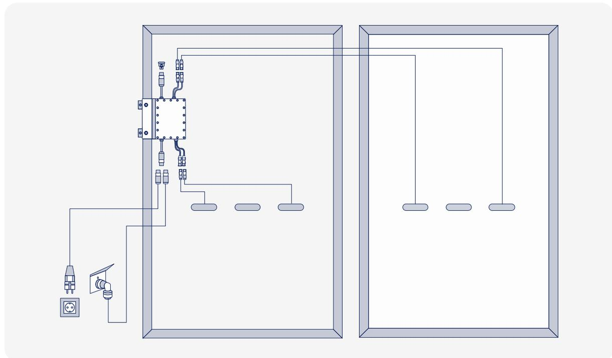
**i** Mit den Kabelbindern kannst du im Anschluss die losen Kabel am Modul befestigen.
