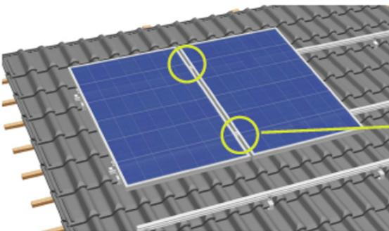
Modul unterschieben und Modulhalter festziehen
