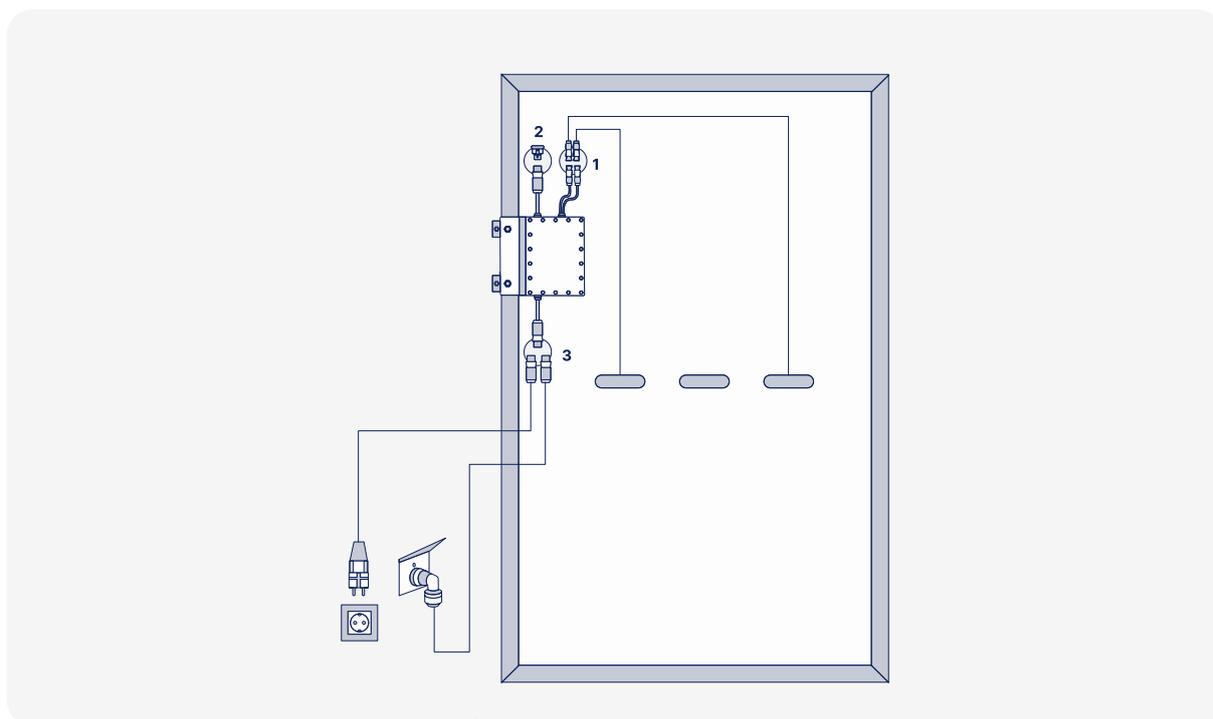
**i** Mit den Kabelbindern kannst du im Anschluss die losen Kabel am Modul befestigen.
